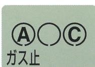
ガス器具の消し忘れなど、長時間ガスを使用され続けた場合。
