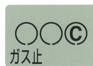
ゴム管の外れなどにより、極めて多くのガスが流れた場合。
